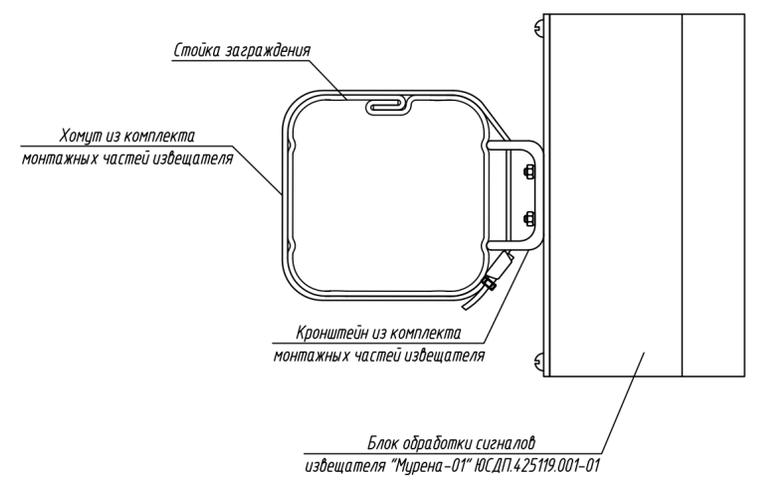
Вариант установки на полотно сетчатого ограждения
