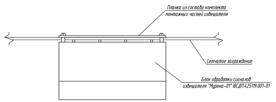
1. Извещатель серии "Мурина" имеет три исполнения: "Мурина" ЮСДП.4.25119.001, "Мурина-01" ЮСДП.4.25119.001-01, "Мурина-02" ЮСДП.4.25119.001-02. Внешний вид и конструкция корпуса одинаковы для всех исполнений.
